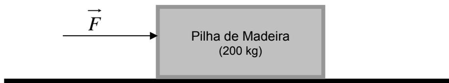
Inicialmente, a pilha de madeira estava em repouso e, para colocá-la em movimento, foi necessária a aplicação de uma força igual a 1200 N. Uma vez iniciado o movimento, os carregadores passam a aplicar, individualmente, uma força igual a 400 N, na mesma direção e sentido de  $\vec{F}$ .
